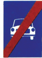
(Π - 26a) Τέλος οδού ταχείας κυκλοφορίας.
